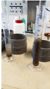
Figure 3 : Eprouvettes avec échantillons filtrés sur 40  $\mu\text{m}$  et 132  $\mu\text{m}$ .
