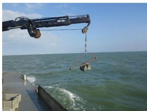
**Figure 4** : Benne de type « Van Veen » actionnée par la grue hydraulique
